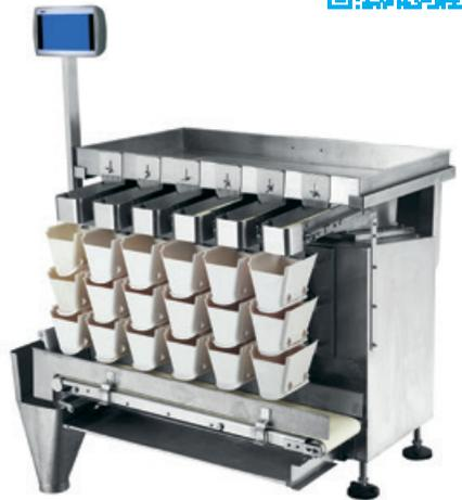
Mit unseren Linearkombinationswaagen erreichen Sie eine hohe Produktionsleistung und Dosiergenauigkeit. Je nach Produkt können angepasste Fördersysteme eingesetzt werden.
